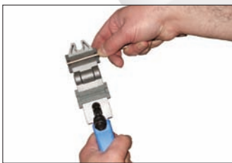
Place pipe in die
